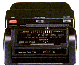
Voor Auto normaal is er keuze uit de diafragma's F4, F5,6 of F8. Bij manual is er keuze uit de richtgetallen 45, 32, 22, 16, 11 en 8 (ISO/ASA 100, meters)
